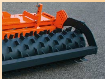
RULLO PACKER ROULEAU PACKER PACKER ROLLER PACKERWALZE RODILLO PACKER УПЛОТНЯЮЩИЙ КАТОК И
